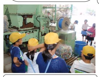
回収したペットボトルを機械で大きなブロックにしている機械の前です。
