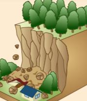
地面にしみ込んだ雨水などが土の抵抗力を弱め、弱くなつた急ながけ地や斜面が突然崩れ落ちることです。地震によって起ることもあります。突然的に起こり、短時間のうちに崩れたり、落石があるので、逃げ遅れた場合、死者が出る割合が高くなります。
