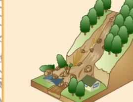
谷や斜面に溜まった土砂が、大雨による水と一緒にになって、一気に流れ出してくれるものです。破壊力が大きく、速度も速いので、大きな被害をもたらします。「山津波」とも呼ばれます。
