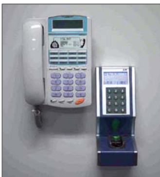
(イメージ例) 入退室管理（サーバ室）
