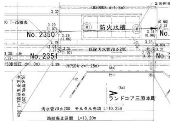
No. 2351 既設組立O号マンホール撤去詳細図
