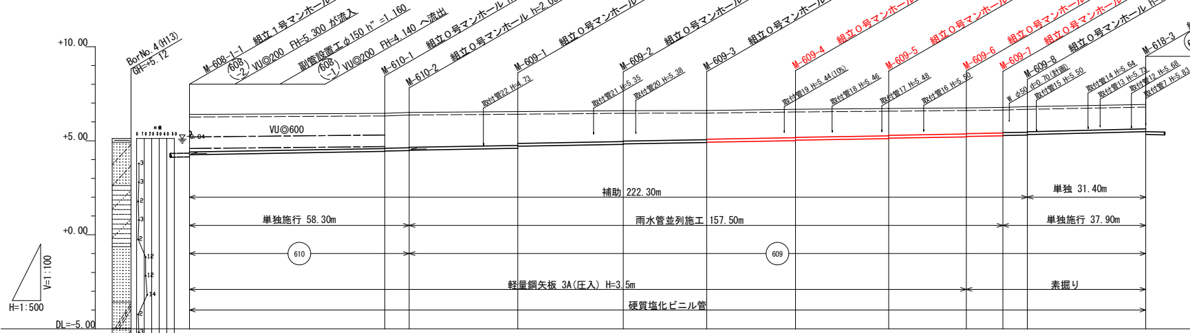
汚水縦断面図 V=1:100 H=1:500
