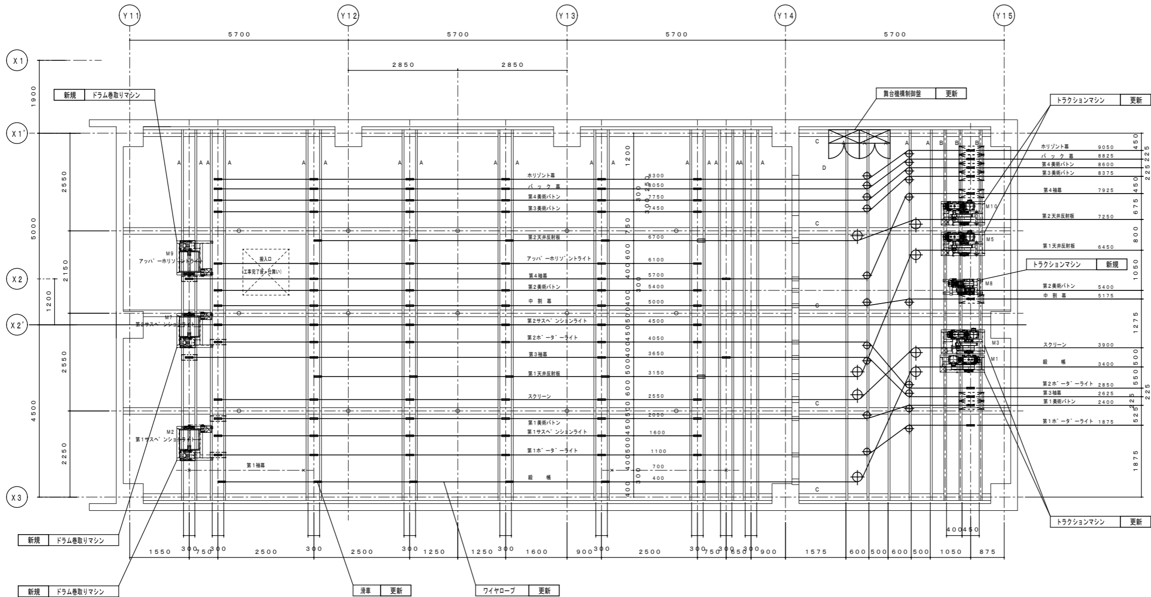
吊物装置 ブドウ棚機器配置図 S=1/50
