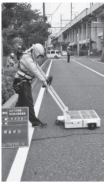
レーザー探査による空洞調査
