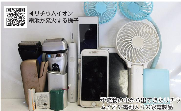
不燃物の中から出てきたリチウムイオン電池入りの家電製品
