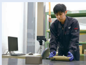
三次元測定機を使って検査
