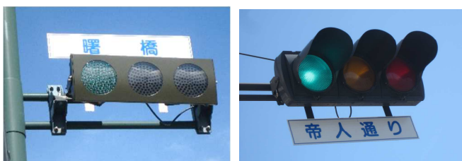
左上…曙橋車用(LED) 左下…曙橋歩行者用 右上…帝人通り車用 右下…帝人通り歩行者用 ※信号機のトリア LED 素子は 1 灯 192 個
