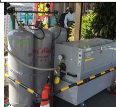
広島ガス(株) 移動式ガス発生設備
