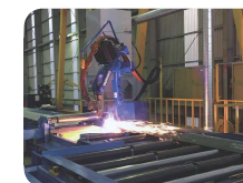
ANS平鋼形鋼 6軸ロボット切断システム
