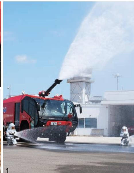
▶1.空港用化学消防車の放水訓練の様子。放水銃は運転席で遠隔操作する。▶2.消防車のポンプやライト類、無線などは毎日点検。▶3.煙などで視界不良になる現場を想定し、目隠しした状態での救難訓練。後輩指導も平岩さんの仕事。
