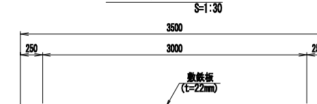
仮設道路 (敷鉄板)
