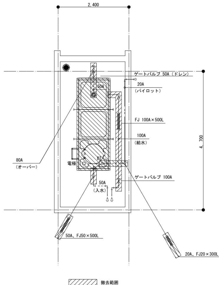
2号棟 PH屋階平面図 (撤去・改修前) 縮尺 1:50
