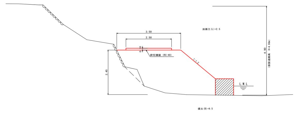
仮締切工平面図 河川幅W≧3.0の場合 S=1:200
