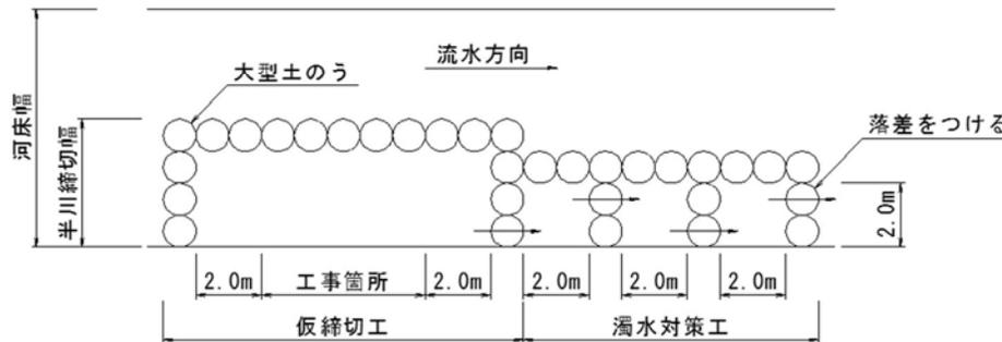
**仮締切工断面図**
