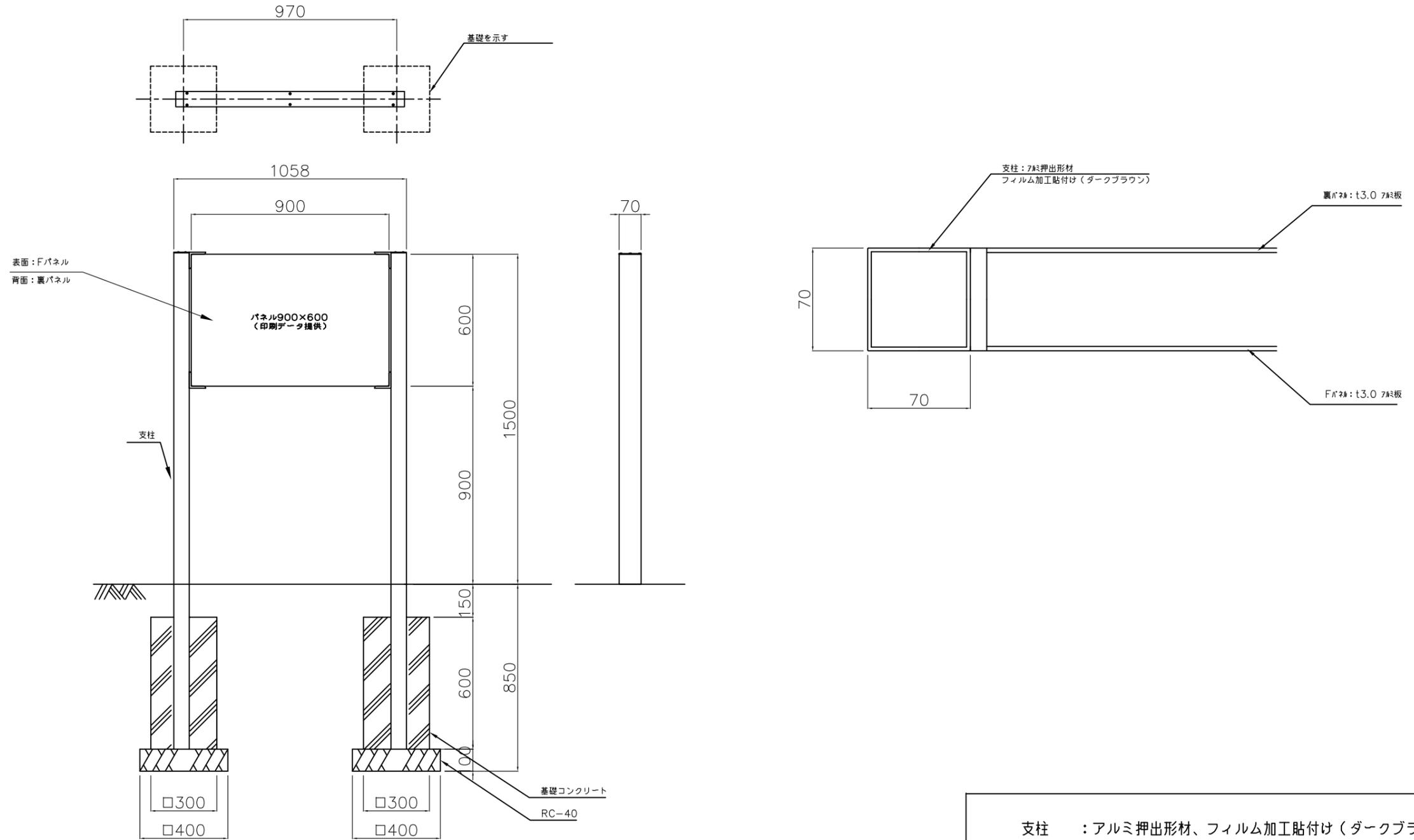
支柱 : アルミ押出型材、フィルム加工貼付け（ダークブラウン）
