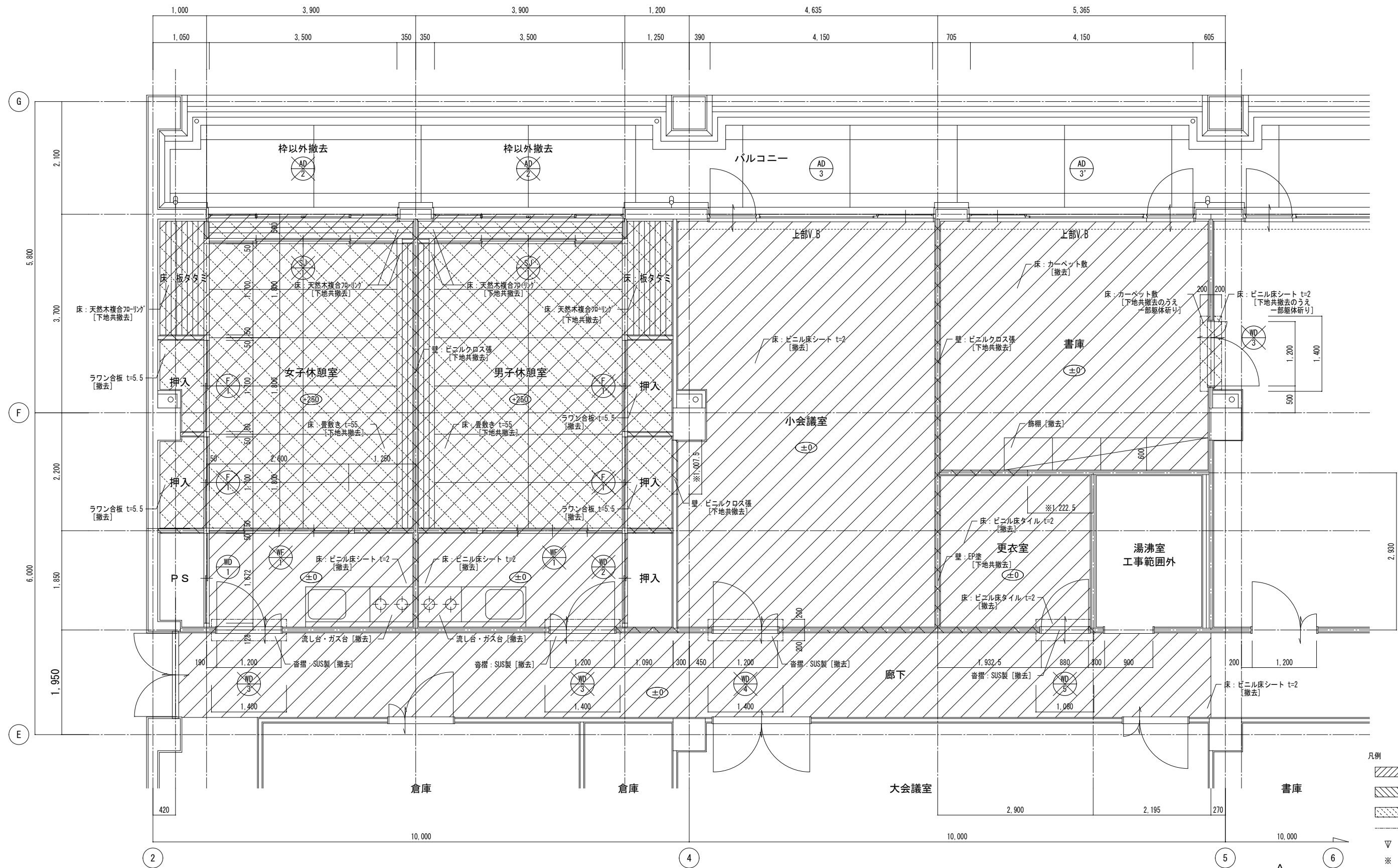
庁舎-平面詳細図(改修前) S=1:50
