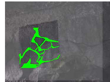
ハッチ部は空隙を示す。間隙率=16.0%
