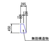
河川横断面図 S=1:200 注) ブロック積みは控え35cmと推定する。
