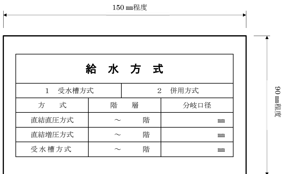
図 8.4.1 給水方式識別表示銘板（参考）
