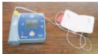
生命に危険があるときに、心臓に電気ショックを与え、正常なリズムに戻す自動体外式除細動器（AED）
