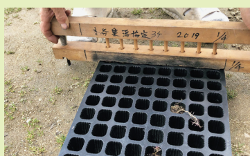
一度に多くの苗を作るために、土に穴を開ける機械を手作りした
