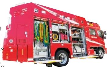
交通事故など救助が必要な現場に出動します。ウインチやクレーンなど100アイテムを超える救助資材を搭載しています。
